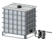
Pompe installée sous la tête (aspiration positive)
